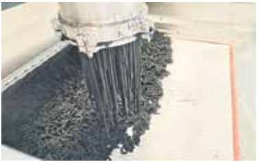
Prkaz nanosa mokrega blata na sušilni trak v procesu sušenja
