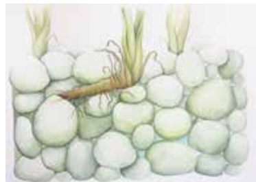
Rastline za rast iz odpadne vode črpajo hranilne snovi in tako povečajo učinek čiščenja. Glavnino čiščenja odpadne vode opravijo mikroorganizmi, ki so pritrjeni na delcih peska pod površjem čistilne grede.
